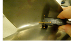
Beispielprüfung eines Propellers mittels Wirbelstromprüfung
